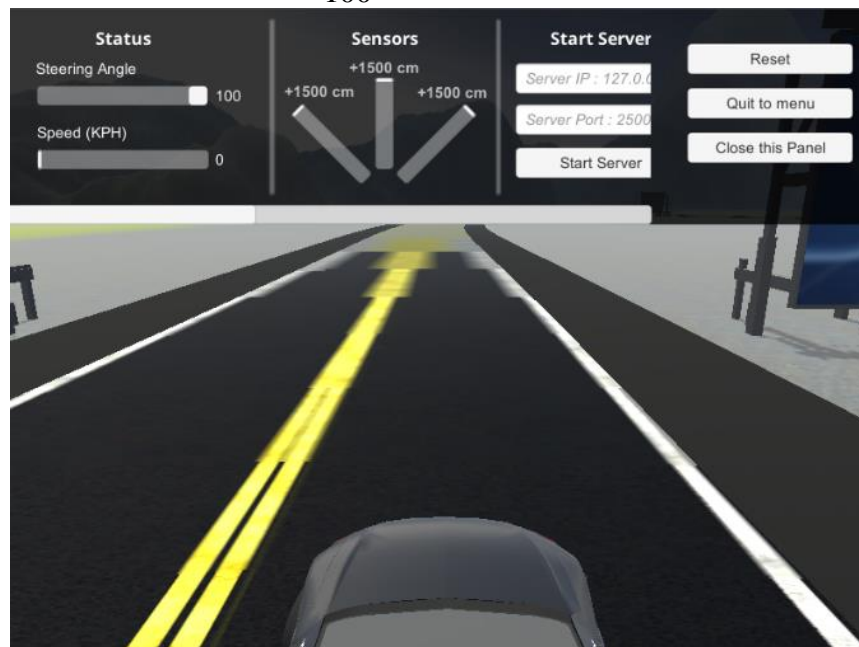
شکل ۸-۲۰ مقدار حداکثر چرخش چرخ‌ها ( +30 درجه و ورودی 100 به عملگر)
