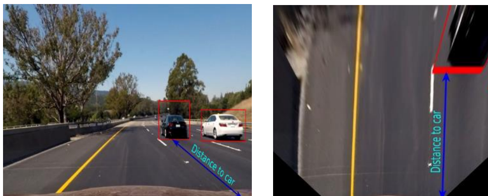
شکل ۲-۳۹ بدست آوردن Perspective Transform جاده و محاسبه فاصله پیکسلی نسبت به خودرو [۲۱۸]
