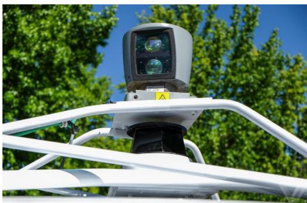
شکل ۱-۱۷ ، نمونه‌ای از دوربین‌های مورد استفاده در سامانه‌های راننده خودکار[۱۳].
