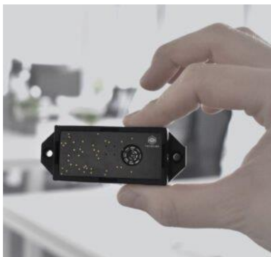
شکل ۱۶-۱، نمونه‌ای از سنسورهای اولتراسونیک مورد استفاده در سامانه‌های راننده خودکار [۱۱].
