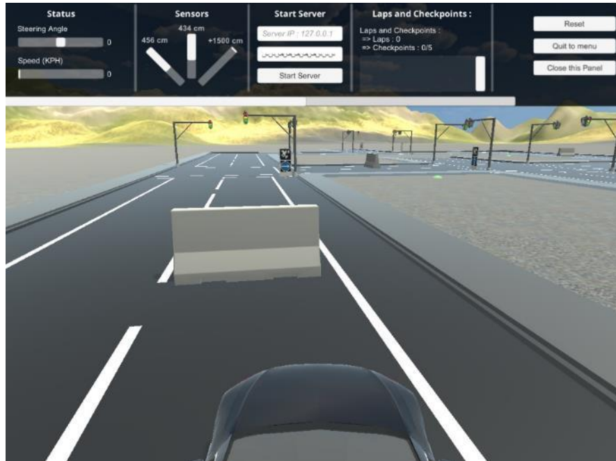
شکل ۲۶-۷ عملکرد سنسور التراسونیک وسط و چپ در محیط شبیه سازی
