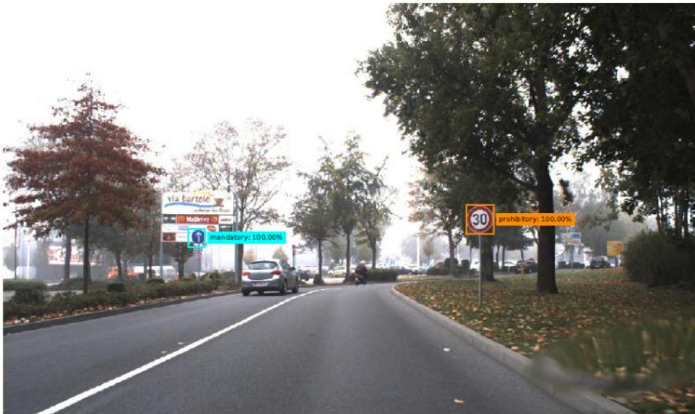
شکل ۱۷-۲ نمونه ای از نتایج مدل‌های آشکارساز علائم راهنمایی و رانندگی [۲۰۱].
