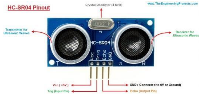
شکل ۲۰-۷ اجزا و پین‌های سنسور الٹراسونیک
