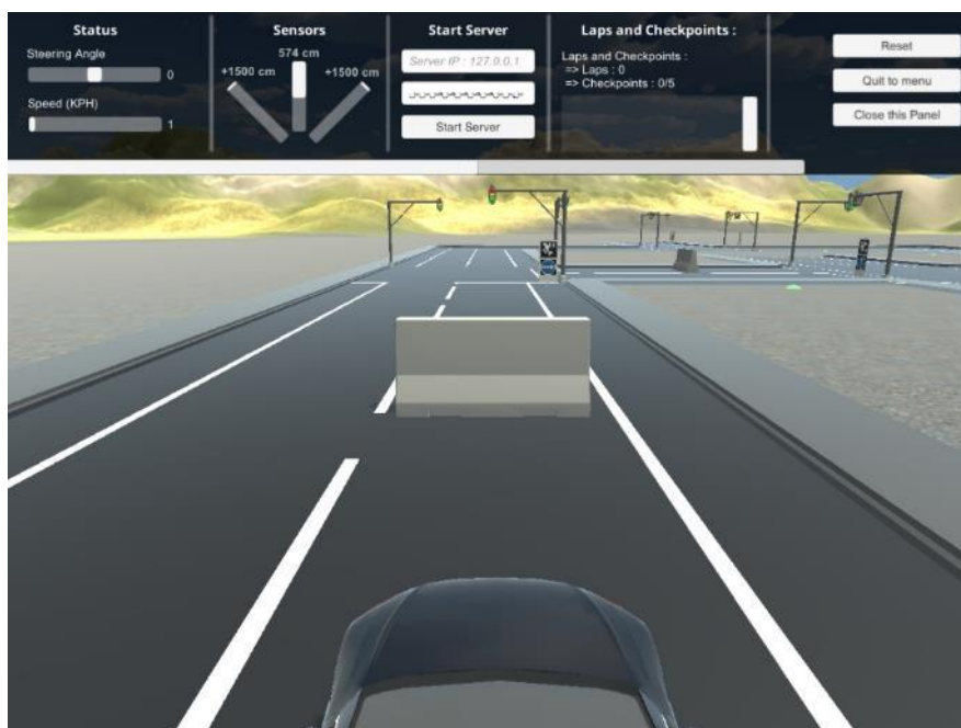
شکل ۲۵-۷ عملکرد سنسور التراسونیک وسط در محیط شبیه سازی
