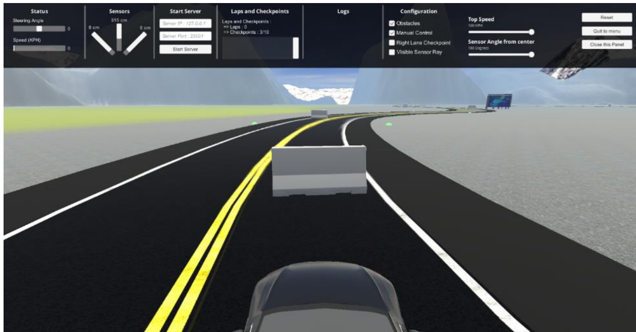
شکل ۶-۲۲ تصویر از قرار گیری موانع در محیط بین شهری
