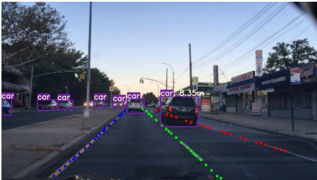
شکل ۳-۸۸ نتیجه خروجی اول اندازه گیری فاصله نسبت به خودروهای دیگر
